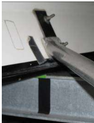
De zwarte tapes op de boot en de tapes op de leggers horen op elkaar te rusten.
