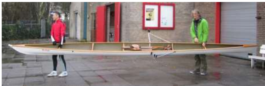
Een gekeerde-C boot wordt gedragen aan de dwarsbalken
