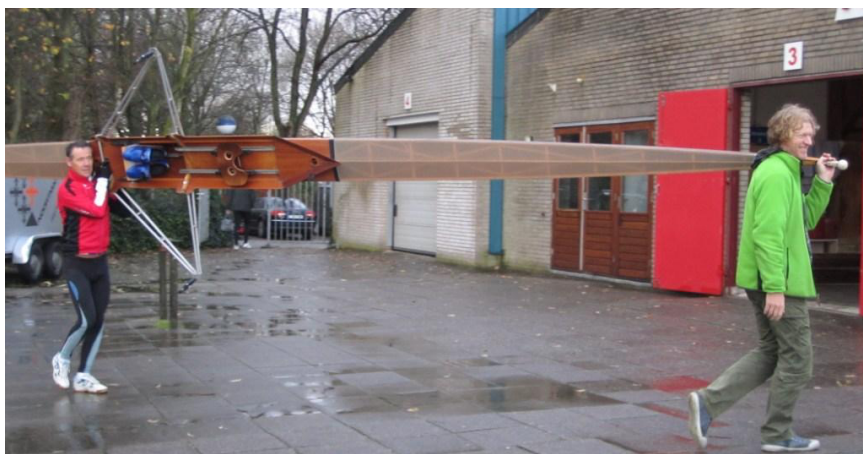
Dragen skiff: roeier aan het hoofdspant draagt de boot, de helper aan de punt ondersteunt
