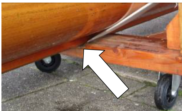
Sommige karren hebben een gleuf waarde kiel van de boot recht in wordt gelegd
